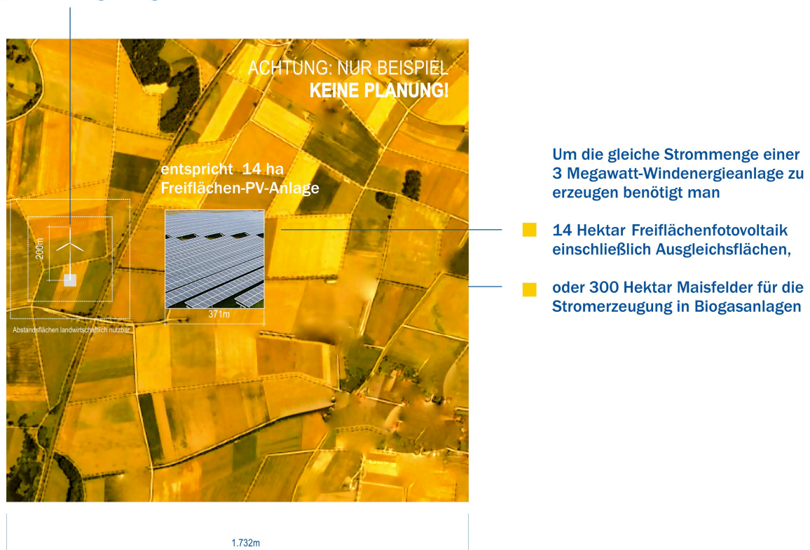
Abbildung 22: Flächenbeanspruchung für eine 3 MW-Windenergieanlage im Vergleich zu Stromerzeugung aus Freiflächen-Fotovoltaikanlage und im Vergleich zu Silo-Maisanbau für Biogasanlagen.
